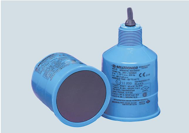
Le transducteur à ultrasons EchoMax XRS-5 garantit la mesure de niveau en continu de liquides et de boues liquides. Solution fiable pour les stations de relèvement étroites, les canaux, les déversoirs et les lits filtrants, il est doté d'un faisceau d'émission étroit (10°) et d'une face émettrice en caoutchouc CSM.
