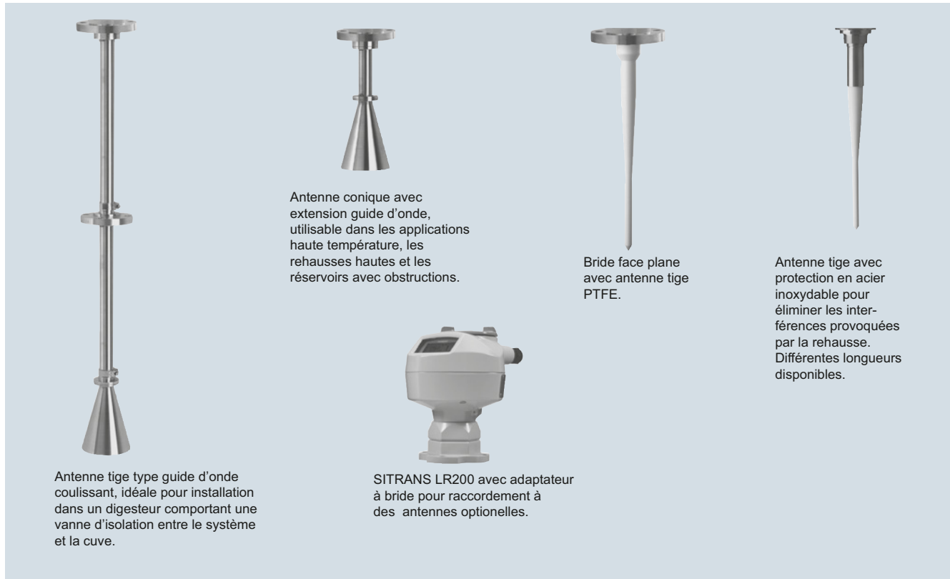
Configurations d'antenne pour SITRANS LR200
