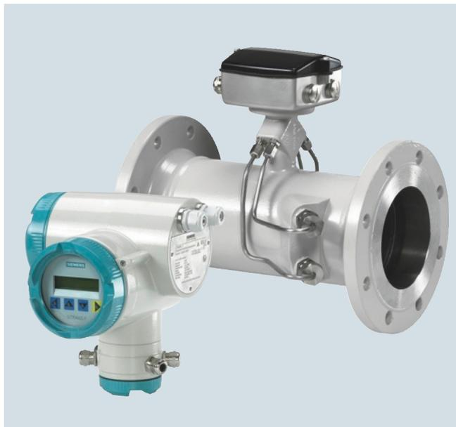
L'ensemble comprenant un capteur SONO 3300 et un transmetteur FUS060 est idéal pour les applications industrielles standard. Les mesures sont réalisables indépendamment de la température, de la densité, de la pression et de la conductivité du liquide. Les transducteurs ne peuvent pas être remplacés.
