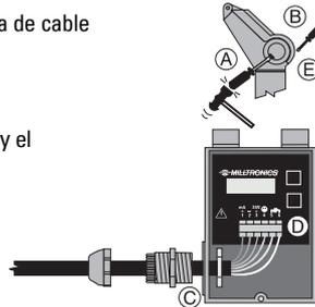
**Nota:** La caja no metálica no garantiza la puesta en tierra entre conexiones. Se recomienda utilizar punzones estancos en las aplicaciones Tipo 4X / NEMA 4X / IP65 (para exteriores).
