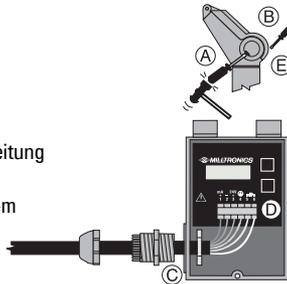
**Hinweis:** Das Gehäuse ist schutzisoliert und besitzt keine Erdverbindung zu der Klemmleiste. Für Typ 4X / NEMA 4X / IP65 Applikationen im Freien dürfen für die Kabeleinführungen ins Gehäuse nur zugelassene Dichtbuchsen entsprechender Größe verwendet werden.
