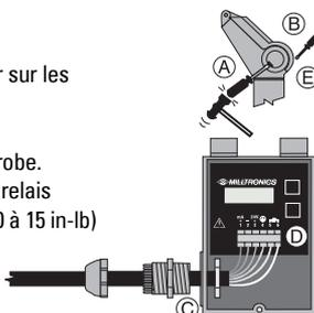
**Note** : Le boîtier non-métallique n'assure pas la mise à la terre entre les connexions. Utiliser des répartiteurs étanches dans les applications Type 4X / NEMA 4X / IP65 (en extérieur).
