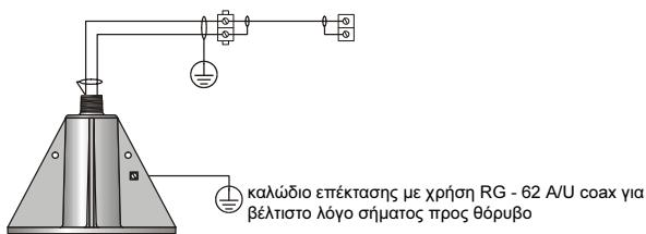
Σημείωση: Η γείωση του μορφοτροπέα, όπως φαίνεται στο σχήμα, επιβάλλεται από τους κανόνες ασφαλείας και για λόγους μόνωσης από ηλεκτρικές παρεμβολές.
