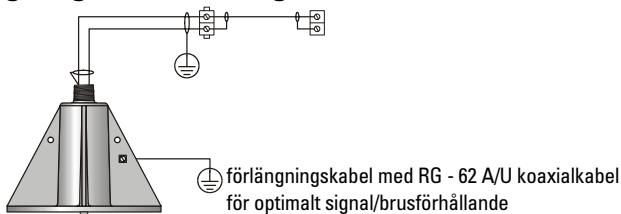
**Anmärkning:** Jordning av transducern så som visas är obligatorisk gentemot säkerhetsföreskrifterna och för isolering mot elektrisk interferens.
