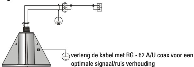
**Opmerking:** Het aarden van de transducer zoals weergegeven is verplicht conform de veiligheidsregels en voor isolatie tegen elektrische interferentie.
