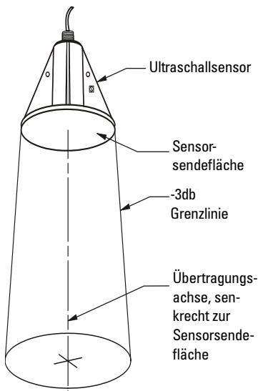
Die XLT Sensoren sind mit einem integrierten Temperaturfühler ausgestattet. Dieser meldet dem Messumformer die Temperatur am Ultraschallsensor.
