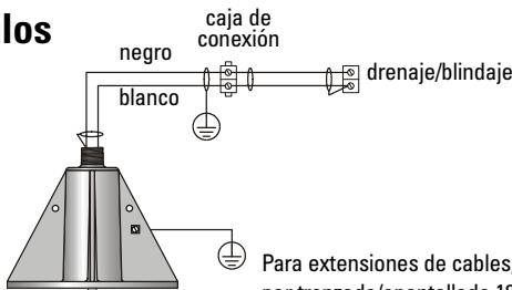
Para extensiones de cables, utilizar cable de par trenzado/apantallado 18 AWG
