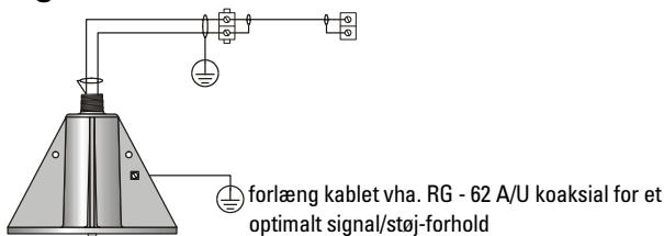
**Bemærk:** Transduceren skal jordforbindes som vist i henhold til sikkerhedsbestemmelserne samt for at isolere den mod elektrisk interferens.
