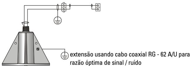
**Nota:** A ligação à terra do transdutor como mostrado é obrigatória segundo os regulamentos de segurança e para isolamento contra interferências eléctricas.
