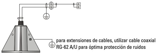
para extensiones de cables, utilizar cable coaxial RG-62 A/U para óptima protección de ruidos
