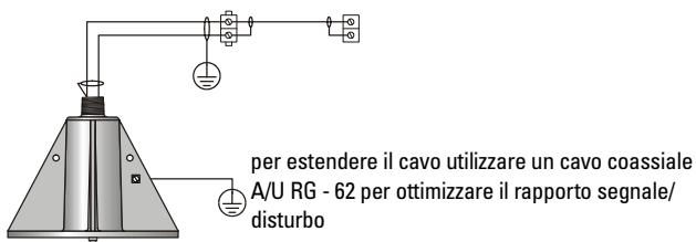
**Nota:** La messa a terra del trasduttore descritta è obbligatoria in conformità con le norme di sicurezza vigenti e per l'isolamento dalle interferenze elettriche.
