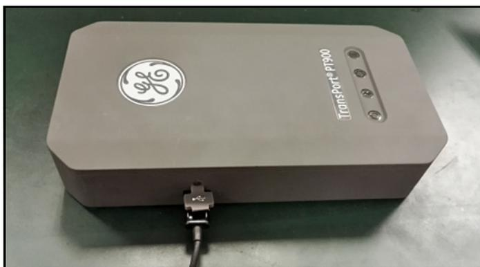
Figure 104 : câble USB connecté au transmetteur
