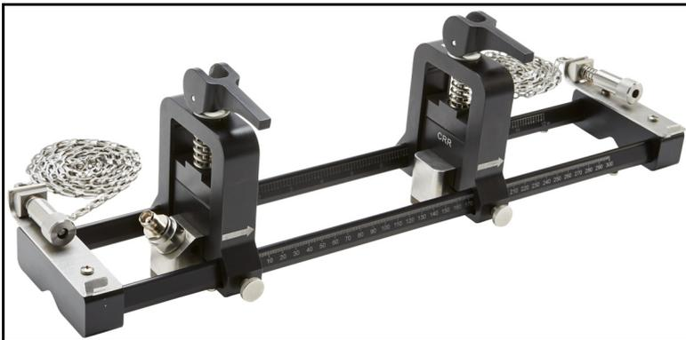
**Figure 7 : Fixation à pinces PT9 avec transducteurs CRR**
