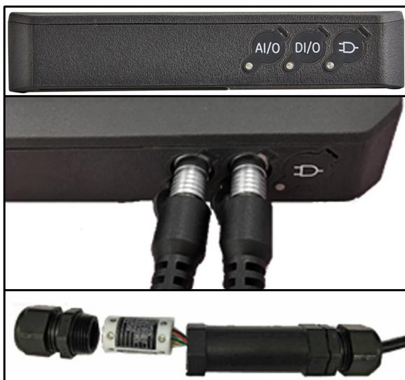
Figure 46 : connexions E/S du transmetteur (côté droit)
