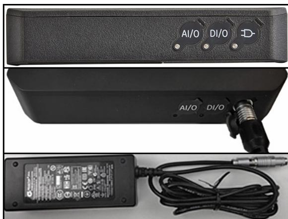
Figure 44 : branchement d'alimentation du transmetteur (côté droit)
