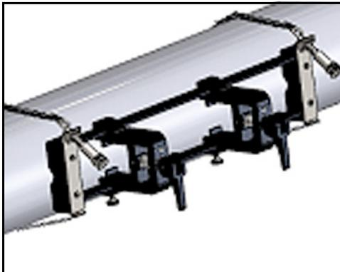
Figure 15 : Fixation pivotée en position horizontale
